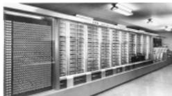
Il pouvait réaliser une multiplication de nombres de vingt-trois chiffres décimaux en six secondes, une division en quinze secondes et des calculs trigonométriques en une minute.
