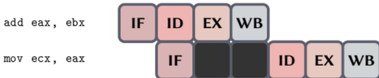
La seconde bulle est nécessaire pour éviter l'aléa structurel **ID vs WB**.
