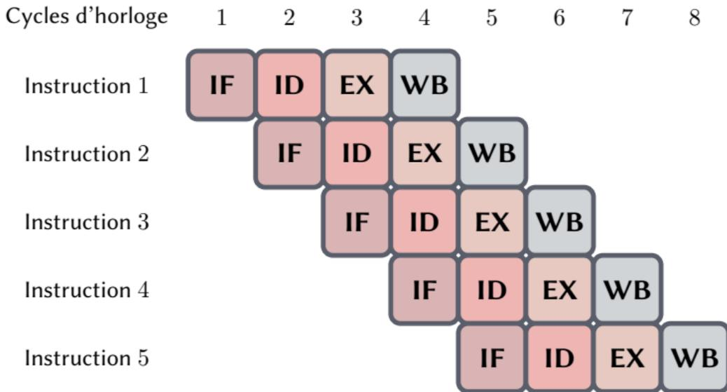
Il permet (dans cet exemple) d'exécuter 5 instructions en 8 cycles d'horloge au lieu de 20.
