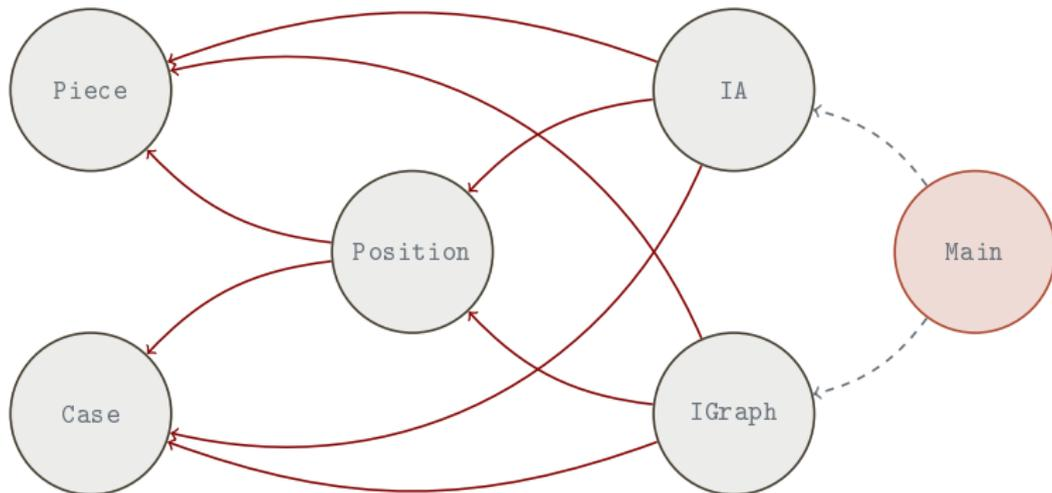
Tout projet contient un fichier source `Main.c`, le **fichier principal** du projet, où figure la fonction `main` (le **point d'entrée** de l'exécution du programme). Celui-ci apparaît dans le graphe d'inclusions.
