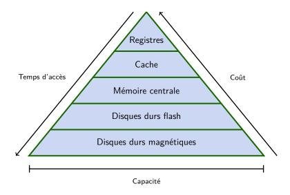
Les caractéristiques principales des mémoires — en plus des dimensions capacité, temps d'accès et coût — sont
