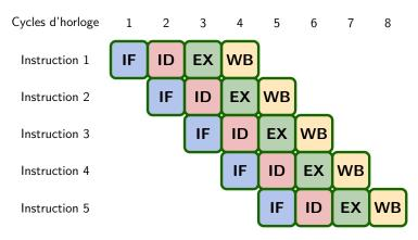
Il permet (dans cet exemple) d'exécuter 5 instructions en 8 cycles d'horloge au lieu de 20.
