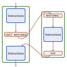
Schématiquement, voici l'action produite sur l'exécution d'un programme par le couple call / ret :
