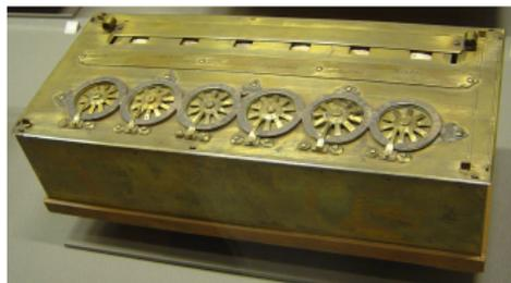
Elle permettait de réaliser des additions et soustractions de nombres décimaux jusqu'à six chiffres.
