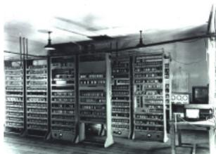
Sa mémoire utilisable est organisée en 1024 régions de 17 bits. Une instruction est représentée par un code 5 bits, suivi d'un bit de séparation, de 10 bits d'adresse et d'un bit de contrôle.
