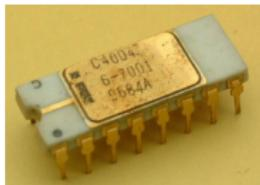
Il contenait 2300 transistors et sa fréquence était de 740 KHz.
