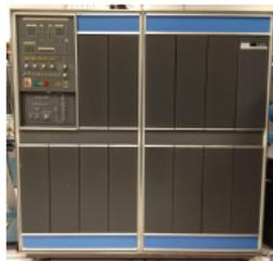
Il pouvait réaliser 193000 additions de nombres de huit chiffres décimaux par seconde et disposait d'une mémoire d'environ 8 Kio.
