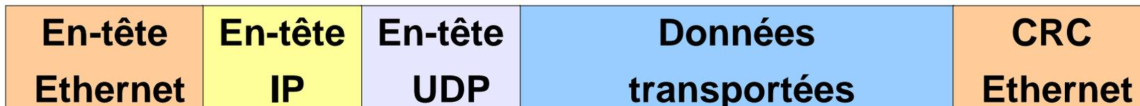
Exemple d'encapsulation dans une trame Ethernet:
