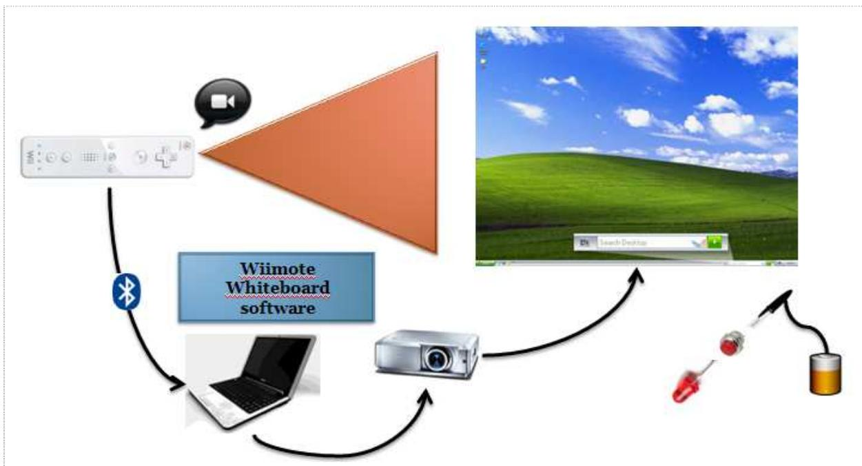
Figure 24. Montage de l'écran tactile du pauvre.
